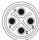
Esquema de polos del conector macho M12, 4 polos, con codificación S, vista de la cara de machos
