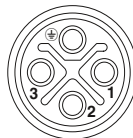
Esquema de polos del conector hembra M12, 4 polos, con codificación S, vista de la cara de hembras
